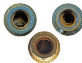
Впускные и выпускные отверстия изношенных регуляторов давления.
