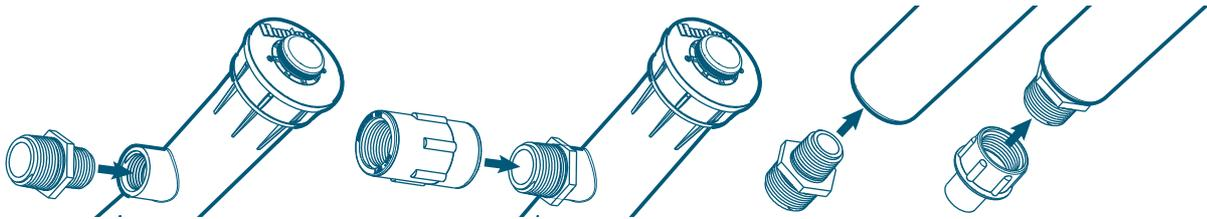
Aunque no es obligatorio, se puede usar cinta de Teflón en las conexiones durante el montaje para mayor seguridad.
