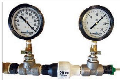
Si votre distributeur dispose d'un appareil de test, vous pouvez également vérifier les valeurs sur un nouveau régulateur de pression correspondant au modèle que vous souhaitez tester.
