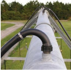
Com a instalação de um pescoço de ganso simples de 125° em lados alternados da linha principal, a área de aplicação molhada é ampliada e pode ajudar a aumentar o tempo de seca.
