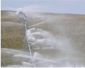
Os aspersores de impacto Pivot Master da Senninger distribuem a água em uma trajetória baixa de 6° e são projetados para resistir à corrente do vento. O amplo diâmetro de jato que oferece exige a aplicação de menos aspersores.
