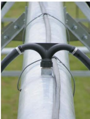
A instalação de goosenecks duplos de 125° permite que o fluxo de cada saída seja dividido ao meio para dois aspersores em cada lado da linha principal. Essa duplicação de gotas é usada para converter máquinas de espaçamento mais amplo em espaçamentos de gotas mais próximos.
